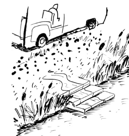
Bloemrijke grasbermen, natuurvriendelijke oevers en betonnen cascade-elementen voor piekafvoer
