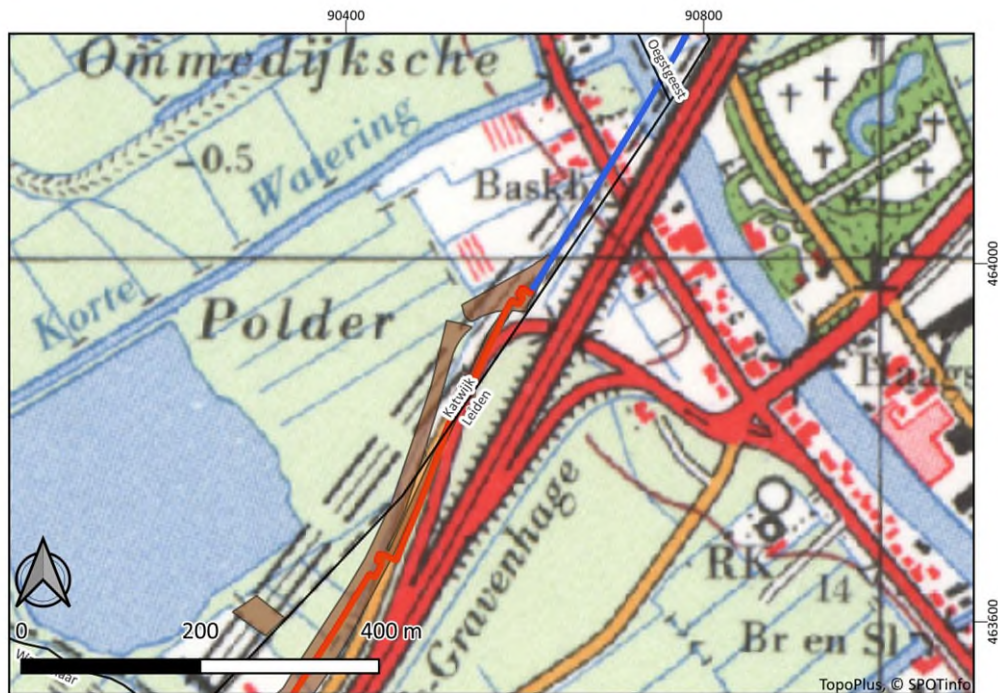
Afbeelding 11. Het plangebied op de topografische kaart van 1970. Aanleg door middel van open ontgraving = rode lijn, aanleg door middel van sleufloze technieken = blauwe lijn. (bron: www.topotijdreis.nl ).
