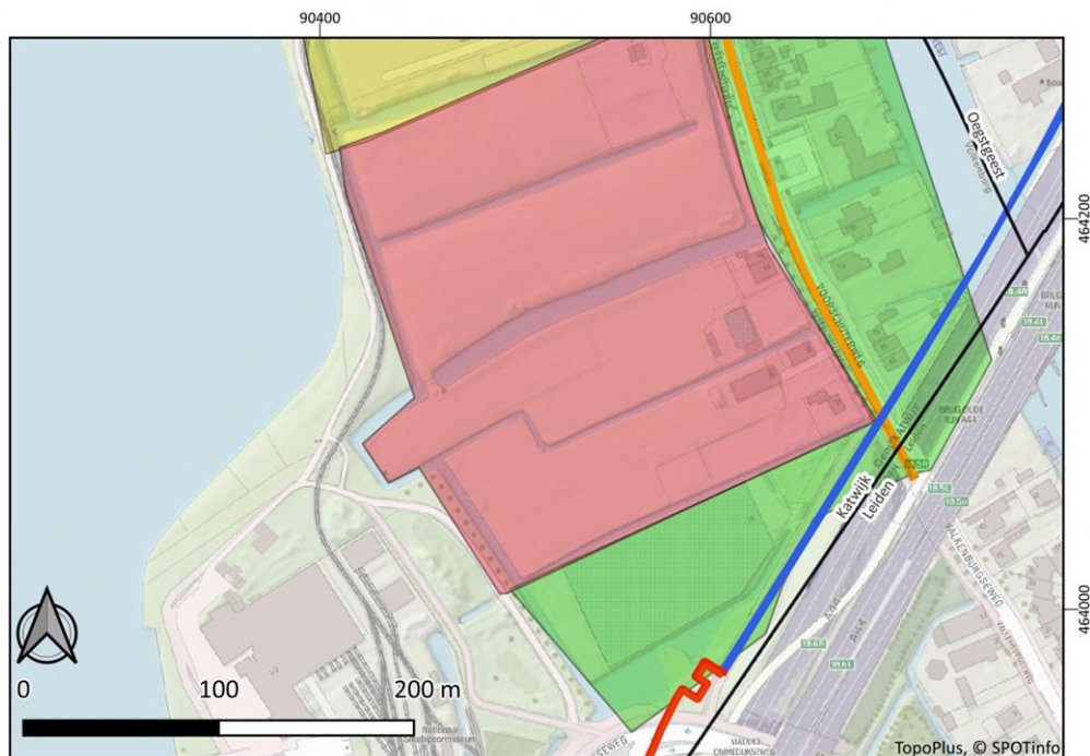
Afbeelding 15. Het plangebied (rode lijn = aanleg open ontgraving, blauw lijn = aanleg sleufloze techniek) geprojecteerd op de archeologische adviesgebieden uit het onderzoek van RAAP uit 2004 (naar: Molenaar, 2004). Aanleg door middel van open ontgraving = rode lijn, aanleg door middel van sleufloze technieken = blauwe lijn. Groen contour = vrijgave; gele zone = booronderzoek na ontbreken betredingstoestemming; rode zone = proefsleuvenonderzoek.
