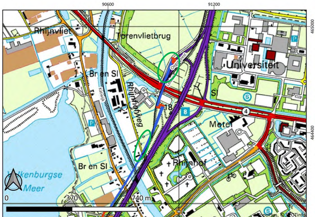
Afbeelding 12. Het plangebied op de topografische kaart van 1999. Aanleg door middel van open ontgraving = rode lijn, aanleg door middel van sleufloze technieken = blauwe lijn. (bron: www.topotijdreis.nl ).
