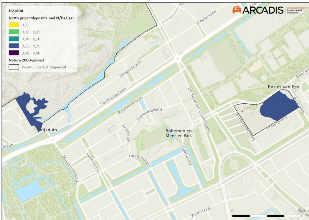
Figuur 5-35 Toename van de stikstofdepositie als gevolg van de aanleg van de warmteleiding op locaties van het habitattype H2180A Duinbossen (droog) met een overschrijding van de KDW in het Natura 2000-gebied Westduinpark & Wapendal.
